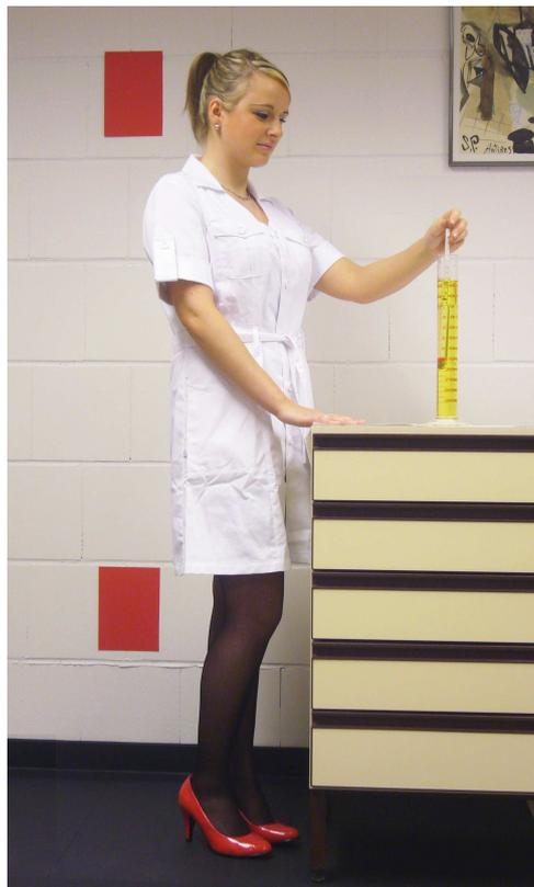
Dichtemessung mit einer Spindel zur Bestimmung der Konzentration
